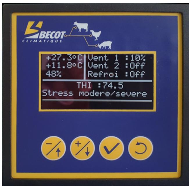
Développé pour les élevages laitiers, le Dairy Clim est un régulateur d'ambiance qui fonctionne avec une sonde de température et d'hygrométrie.
