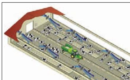
Utilisation de ventilateurs MFS pour le rafraîchissement et la ventilation au sein d'une structure d'élevage ouverte.
